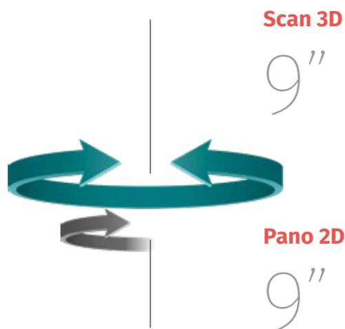
Grazie alla funzione 1Click-2Scan ACX03 vi permette di eseguire una scansione 3D e durante il movimento di ritorno del sensore una panoramica 2D senza ulteriori operazioni.
