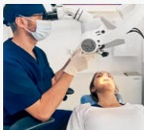
La corretta illuminazione è fondamentale sia per la diagnosi che per ridurre lo stress visivo. Per mantenere la temperatura colore di 5500°K, ideali per le applicazioni odontoiatriche, ATOM MSX utilizza LED delle tre componenti base (RGB, rosso, verde e blu) la cui intensità viene controllata elettronicamente in modo individuale.
